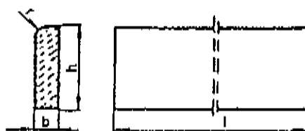
Rysunek 1. Kształt betonowego obrzeża chodnikowego
